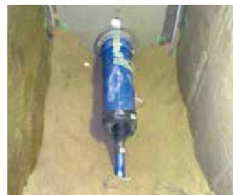
埋設沈下実験 ((独)土木研究所内土槽)
