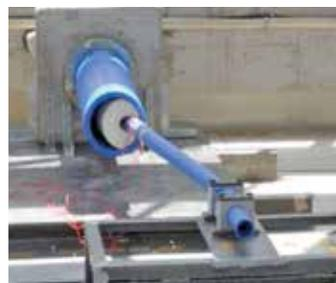
架空配管による水平変位実験 (UR都市機構3次元振動台)
