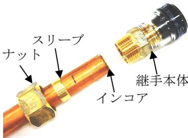
銅管にナット、スリーブ、インコアの順番で取付けた後、管を継手本体に挿入して、ナットを手締めしてください。
