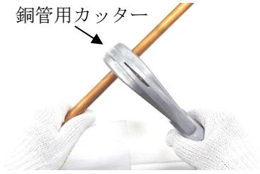
銅管を銅管用カッターにて管軸に直角になるよう切断してください。
