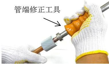
管端のバリを銅管用のリーマ もしくは バリ取り工具にて除去してください。
