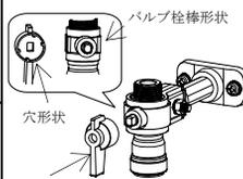
●継手一体型止水栓のバルブ栓棒部に「バチン」と音がするまで確実にハンドルを押し込み、取り付けてください。この時、バルブ栓棒先端の形状とハンドルの穴形状が合うようにしてください。
