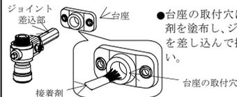
●台座の取付穴に塩ビ管用接着剤を塗布し、ジョイント差込部を差し込んで接続してください。
