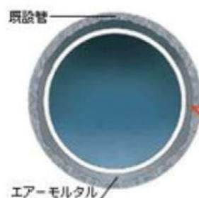
図1. エスロンRCP(強化プラスチック複合管「FRPM管」)
