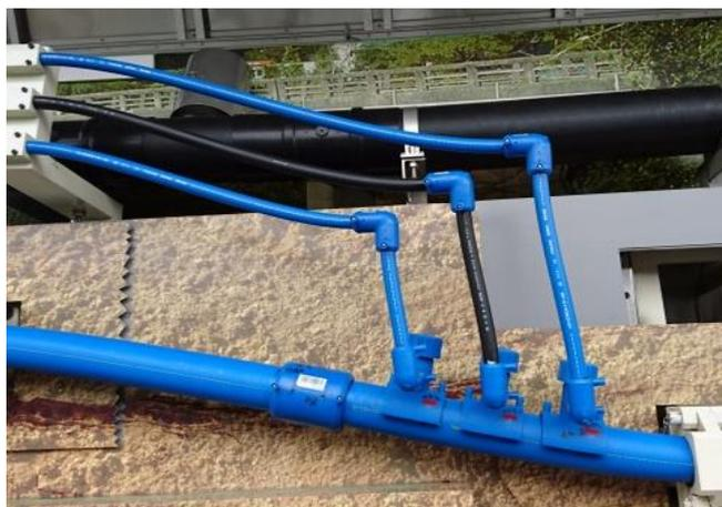
給水分岐部の性能試験
