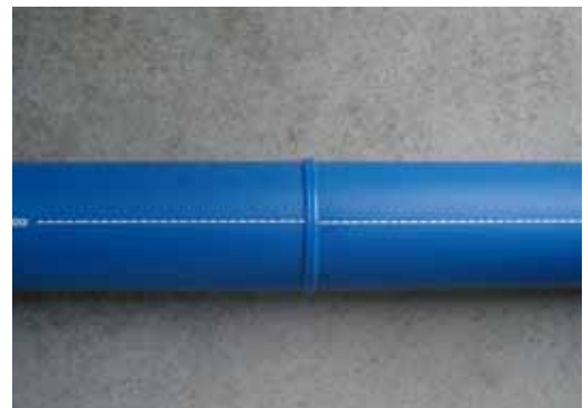
写真3 バット接合部
