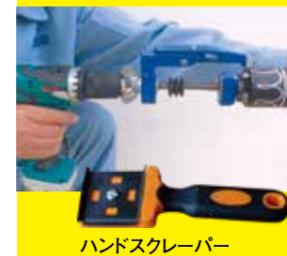
専用のスクレーパーでマーキングした部分が完全に消えるように、挿入長さより5mm程度のスクレープ余長まで切削します。
