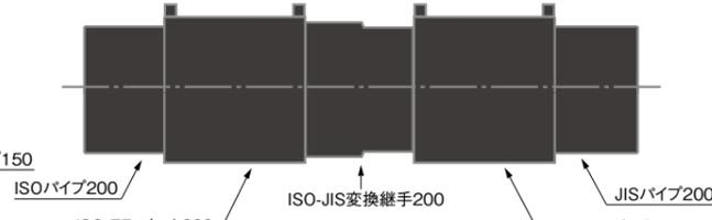
プラントハイパー BK 施工後の水圧漏れ試験方法
