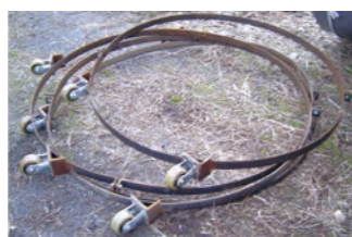
老朽管の中の運搬は、車輪付きバンドを管本体にセットし、人力で行います。
