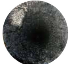
MAPが付着した汚泥配管内部
