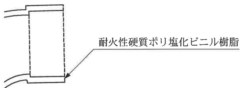
図-2 硬質ポリ塩化ビニル管継手（黒鉛微量入り）の断面構造
