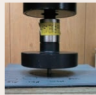
耐荷重試験で設置面の凹み量を確認
