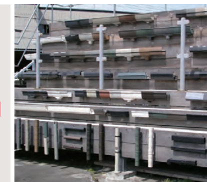
自然環境での屋外暴露試験によって耐候性を確認(当社暴露試験場)
