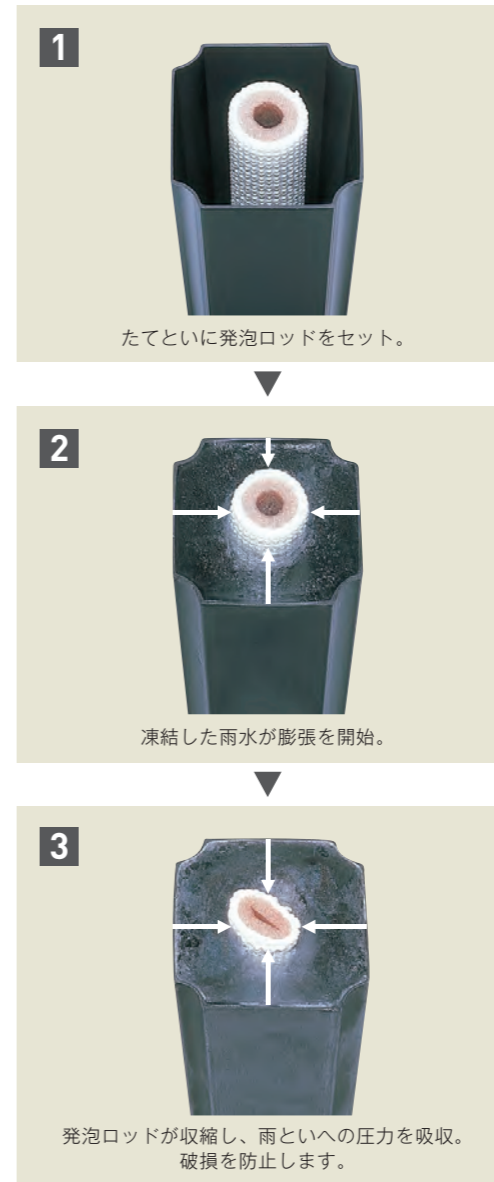
凍結防止ロッドの仕組み
