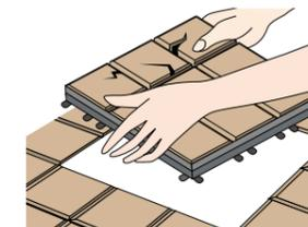
※タイルが割れた場合は、破片でケガをしたり、バルコニーの下地を傷つける恐れがありますので、すぐに破損部を掃除し、破片を取り除いてください。
