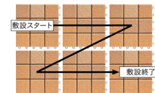
通常、タイルは手すり側から順に一方方向に敷設されているため、取り外す際には、室内側の一番手前の左右端いずれかのタイルから取り外せます。
