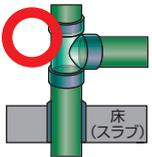
継手の埋設(呼び径125以下の場合)
