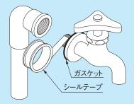
●補助的にシール剤を使用する際は、当社の推奨シール剤をご使用ください。 ●シール剤が適応する塩ビ管継手は、給水栓エルボ、給水栓チーズ等の 金属インサート製品(金属ねじ接続)が対象となります。
