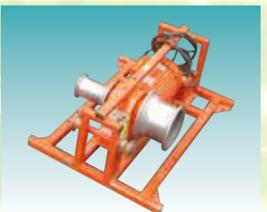
パイプ引き込みに使用。電動1~3t程度の牽引力で引き込み可能です。
