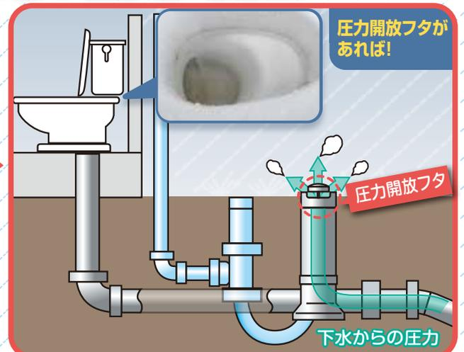
フタで圧力を逃がし、封水跳ね出しを防止します
