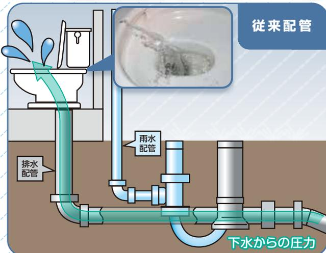
下水本管からの空気の逆流で、排水器具の封水が跳ね出す恐れがあります
