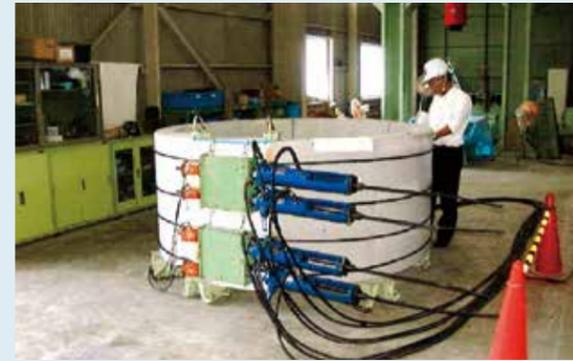
シークークの1cm分の引抜荷重を測定した結果、設計値以上を記録。
