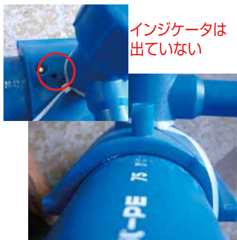
インジケータは 出ていない クランプを使用しなかったため、 サドルが持ち上がった
