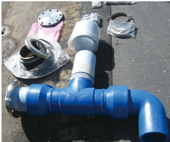
マンホール内副管
