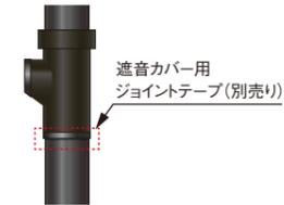
耐火VPパイプ遮音カバー巻きと耐火DV継手を接着接合し、継手と耐火VPパイプ用遮音カバーに遮音カバー用ジョイントテープ(別売)を巻き付け、よくなじませてください。
