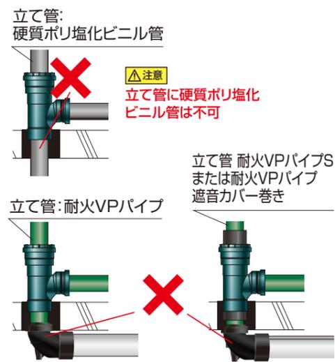
※防火区画貫通部から1m以内の範囲は、横枝管に耐火VPパイプ、耐火DV継手・透明耐火DV継手もしくは認定書・評価書に記載の管種をご使用ください。
