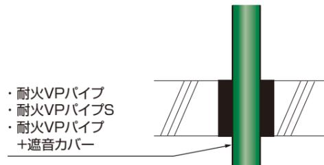
※防火区画貫通部から1m以内の範囲は耐火VPパイプ、耐火DV継手、透明耐火DV継手をご使用ください。
