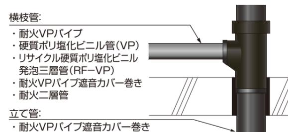
△注意 耐火VPパイプSは耐火DV継手遮音システムにはご使用いただけません。
