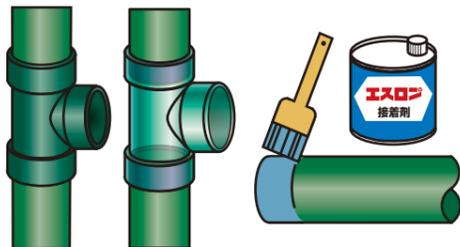
下記の接着剤を使用して、継手の内面、管の外面の順に適量を均一に塗布します。
