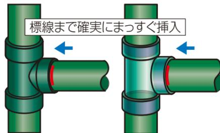
継手受口と管差口の軸を合わせ、速やかに標線の位置まで挿入します。その後、30秒以上保持し、抜け戻りがないことを確認します。
