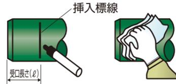
受口長さ(L)と同じ長さの挿入標線を記入します。その後、継手受口内面と管差口外面を乾いたウエスできれいに拭きます。
