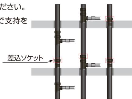
■耐火VPパイプ+耐火プラADミニ継手 標準施工法
