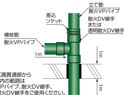
※防火区画貫通部から1m以内の範囲は耐火VPパイプ、耐火DV継手、透明耐火DV継手をご使用ください。
