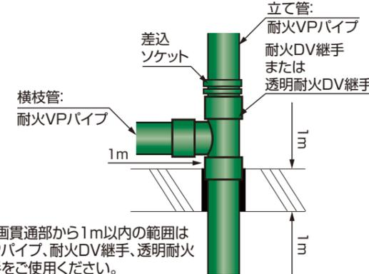
※防火区画貫通部から1m以内の範囲は耐火VPパイプ、耐火DV継手、透明耐火DV継手をご使用ください。
