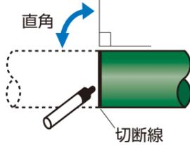
切断箇所は正しく寸法を出し、油性ペン等で管軸に直角に切断線を記入しバンドー、塩ビ用ノコギリを用いて切断します。
