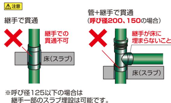
※呼び径125以下の場合、継手一部のスラブ埋設は可能です。
