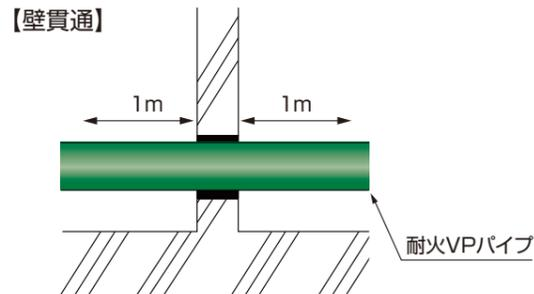
※防火区画貫通部から1m以内の範囲は耐火VPパイプ、耐火DV継手・透明耐火DV継手をご使用ください。
