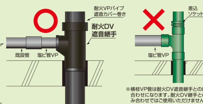
※横枝VP管は耐火DV遮音継手との組み合わせになります。耐火DV継手との組み合わせではご使用いただけません。
