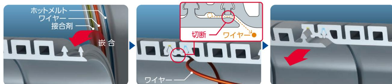
プロファイルの嵌合時に接合剤塗布・ワイヤー設置を実施し製管します
