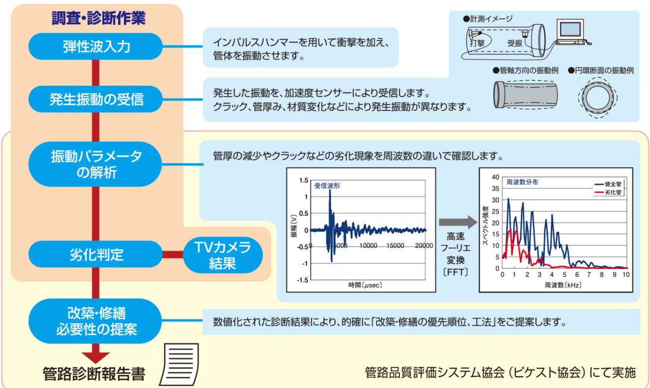
※衝撃弾性波検査では、改築・修繕の優先順位や工法選定となる「軸クラック」等を管体1本ごとに判定し、管体の残存強度を評価します。
