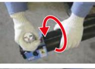
保護層カッターを管端に取り付け、レバーを円周方向にセットしてから2回転させます。
