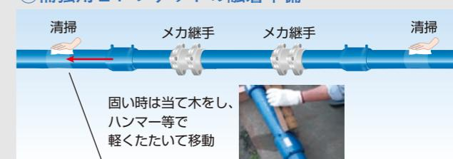
円形に矯正後、前もってスクレーブした区間の汚れをアセトンで再度清掃します。補強用EFソケットを圧着部の中央に移動します。
