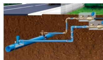
エスロハイパー JWと同じPE100グレードの青い給水管です。耐震管に区分されるエスロハイパー JWから、EFプラグ付きサドル等により、分歧部を含めEF接合(エレクトロfusion接合)が可能。配水・給水ラインの一体化により、給水システムの耐震化・長寿命化を実現します。
