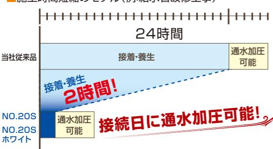
1 接着強度の発現が早く、2時間の乾燥養生で通水加圧可能
