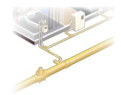
給水装置としてのポリエチレン管・融着サドルは、「耐震性の高い管種、継手」として使用可能。
