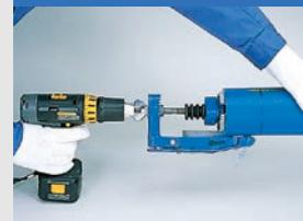
ペンでマーキングした部分及び標線が完全に消えるまで専用切削工具で切削してください。
