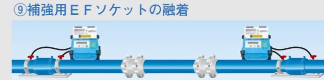
補強用EFソケットを融着して作業完了です。
