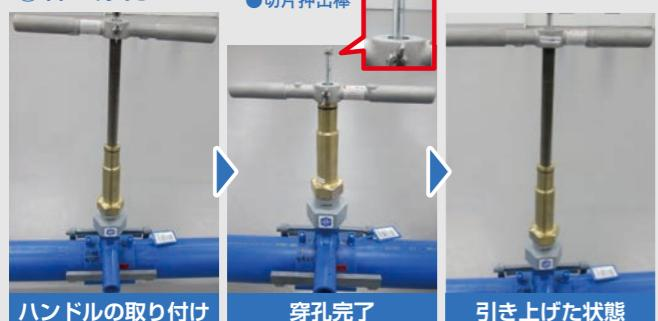
1) 穿孔機にハンドルを差し込み、蝶ネジで固定します。
