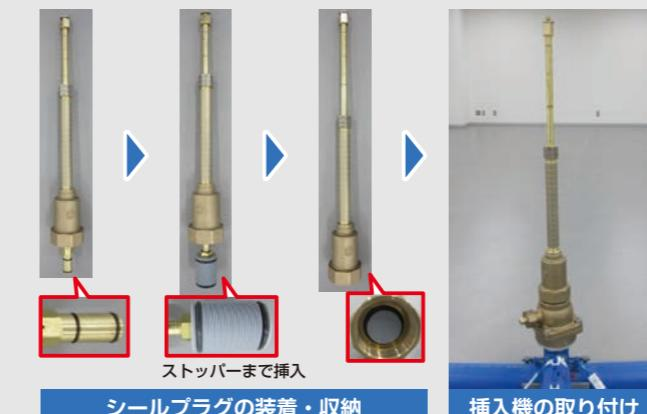
1) シールプラグを挿入機にセットした後、挿入機本体に収納します。
