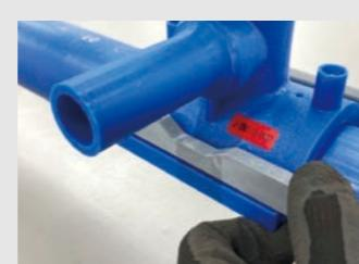
1)バーをサドル分岐側ツバにセットします。
