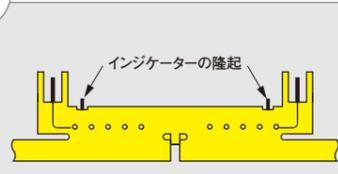
面圧の発生によりインジケータが隆起し、接合が完了します。冷却終了後は内部応力が残りにくい接合方式です。
