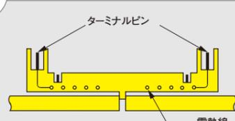
管外面の切削を行います。次に管表面および継手内面をアセトンで清掃し、継手と管を接続します。
