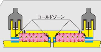
溶けた樹脂はコールドゾーンで密封され、膨張して面圧が発生し融着されます。
