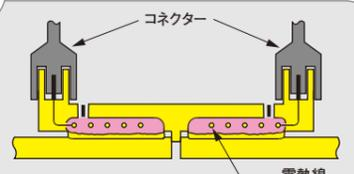
コントローラーのコネクターをターミナルピンに接続します。通电により電熱線を発熱させ、管表面および継手内面の樹脂を溶かします。
