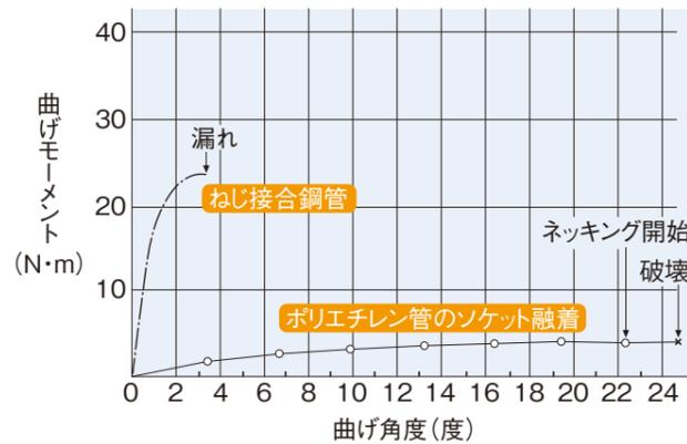
上図の通り、ポリエチレン管は鋼管と比較して、柔軟に曲げに対応するといえます。
