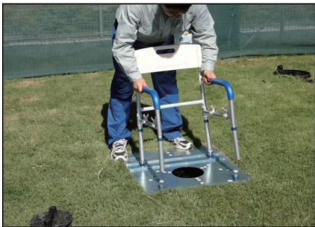
4-2. 台座上部に便座設置
