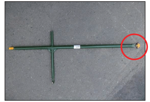
3. マンホール蓋開閉パール全景 (赤丸部分をマンホールに差込む)
