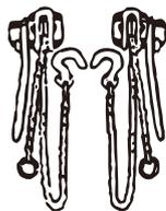
●補助挿入機については、短管やFT-R異形管などの挿入時、管が移動し挿入が困難となった場合に、管上にセットして使用します。
