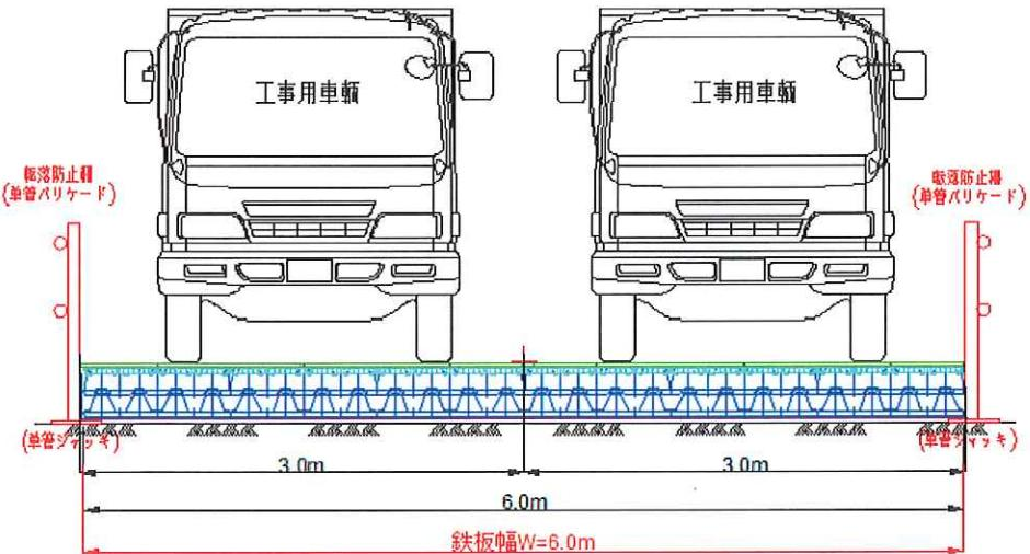
一方通行同様に、プラロード仮設道路から車両が転落しない様に転落防止柵（単管バリケード）を設置し、車両の転落防止を図る。
