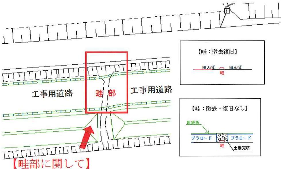
※撤去・復旧が基本。撤去・復旧をしない場合は畦手前で仮設道路を止め水路補強同様に土嚢で充填した後に上部へ鉄板を流す。
