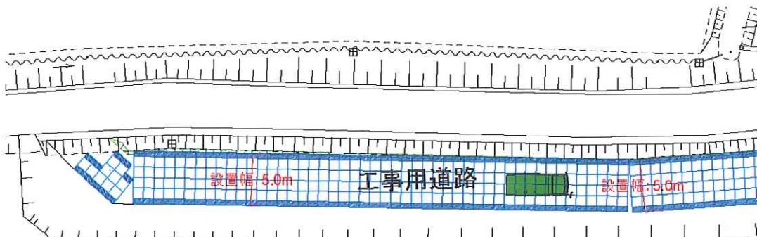
※一方通行の設置幅は5.0mとする。施工延長は本体工事に沿う形とする。
