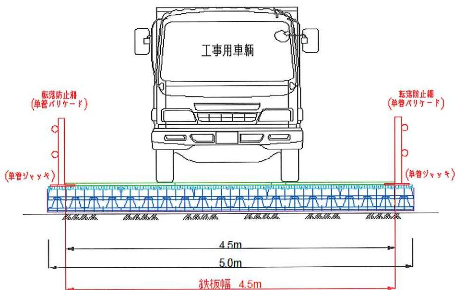
プロロード仮設道路からの車両が転落しない様に転落防止柵（単管バリケード）を設置する事により、車両の転落及び仮設路の位置が現場場内で明確に分かる。
