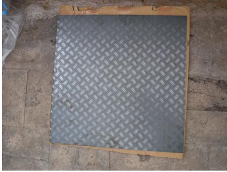
図 4.5.5 ベースプライマー塗布前(鉄)
