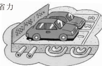
ロードヒーティング用配管
