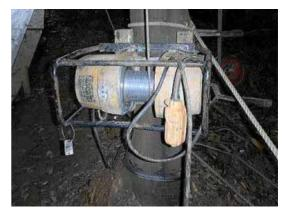
配管に使用したウインチ。 小型のもので十分対応できます。
