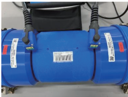
写真2 EF融着で接合可能なPINP専用管
