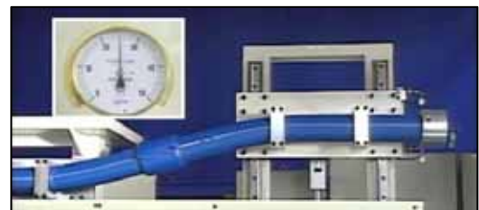
写真2 剪断試験（内圧：2.5MPa、変位：30cm）
