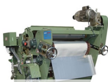
脱水機 (汚泥減容設備)
