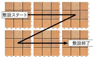
通常、タイルは手すり側から順に一方向に敷設されているため、取り外す際には、室内側の一番手前の左右端いずれかのタイルから取り外せます。
