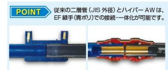
また、継手部は、EF継手、金属継手、メカニカル継手の3種類が紹介されています。「水道用ポリエチレン二層管」にも、EF接続が新規で紹介されており、従来のポリエチレン管においても融着の技術が活用できることが紹介されています。
