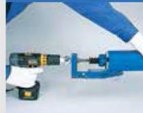
ペンでマーキングした部分が完全に消えるまで専用切削工具で切削してください。
