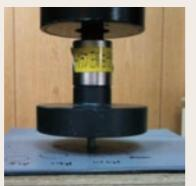
耐荷重試験で設置面の凹み量を確認
