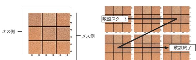
通常、タイルは手すり側から順に一方向に敷設されているため、取り外す際には、室内側の一番手前の左右端いずれかのタイルから取り外せます。
